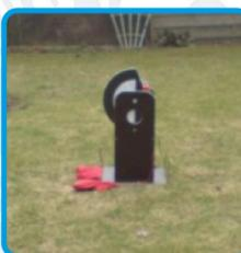
Abb. 7: Gestell zum kontrollierten Drehen des Sensors.
