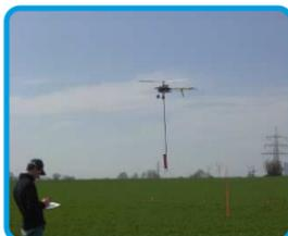
Abb. 1: UAS Magnetfeldmessung bei Köln.
