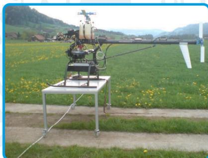
Abb. 4: Aufbau des Hubschraubers bei der Noisemessung in Luzern.
