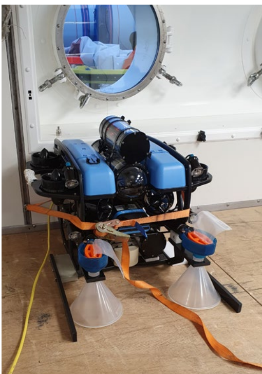
Tauchroboter (BlueROV2) des MARUM zur Beprobung und Observation von natürlichen Gasaustritten in der Nordsee.
