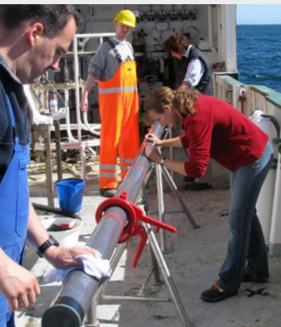
Ein Sedimentkern aus dem deutschen Nordseesektor wird beschriftet und zerteilt, bevor er anschließend geöffnet und analysiert wird.
